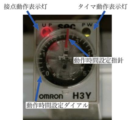
図 7: タイマの動作時間設定および動作表示灯
