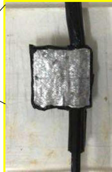
抵抗の変化から 鋼板の腐食を検知
