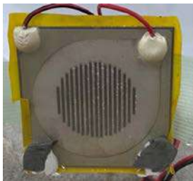
コンクリート内部の 濡れ環境評価
