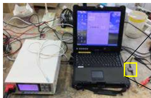
抵抗の変化から 鋼板の腐食を検知
