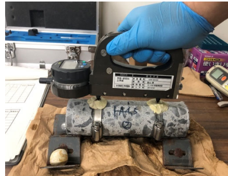
(b) コンタクトゲージによる測定状況
